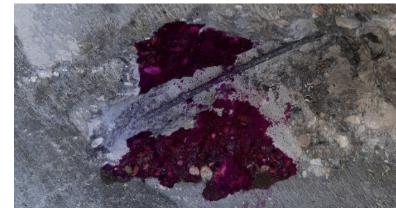
Ermittlung Betondeckung, Be- wehrung ( \varnothing 8/100 = 5,03 \text{ cm}^2/\text{m} ) Karbonatisierungstiefe
